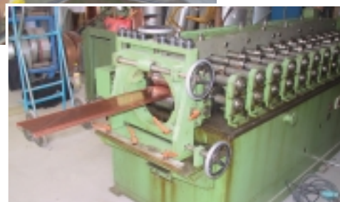
Profiliermaschine für die FS-Profile.
